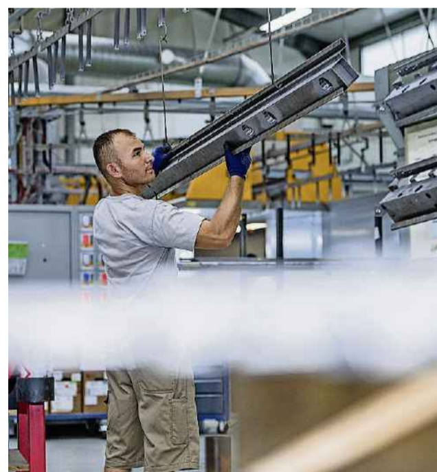
Bis zu drei Meter lange Einzelteile können lackiert werden.
