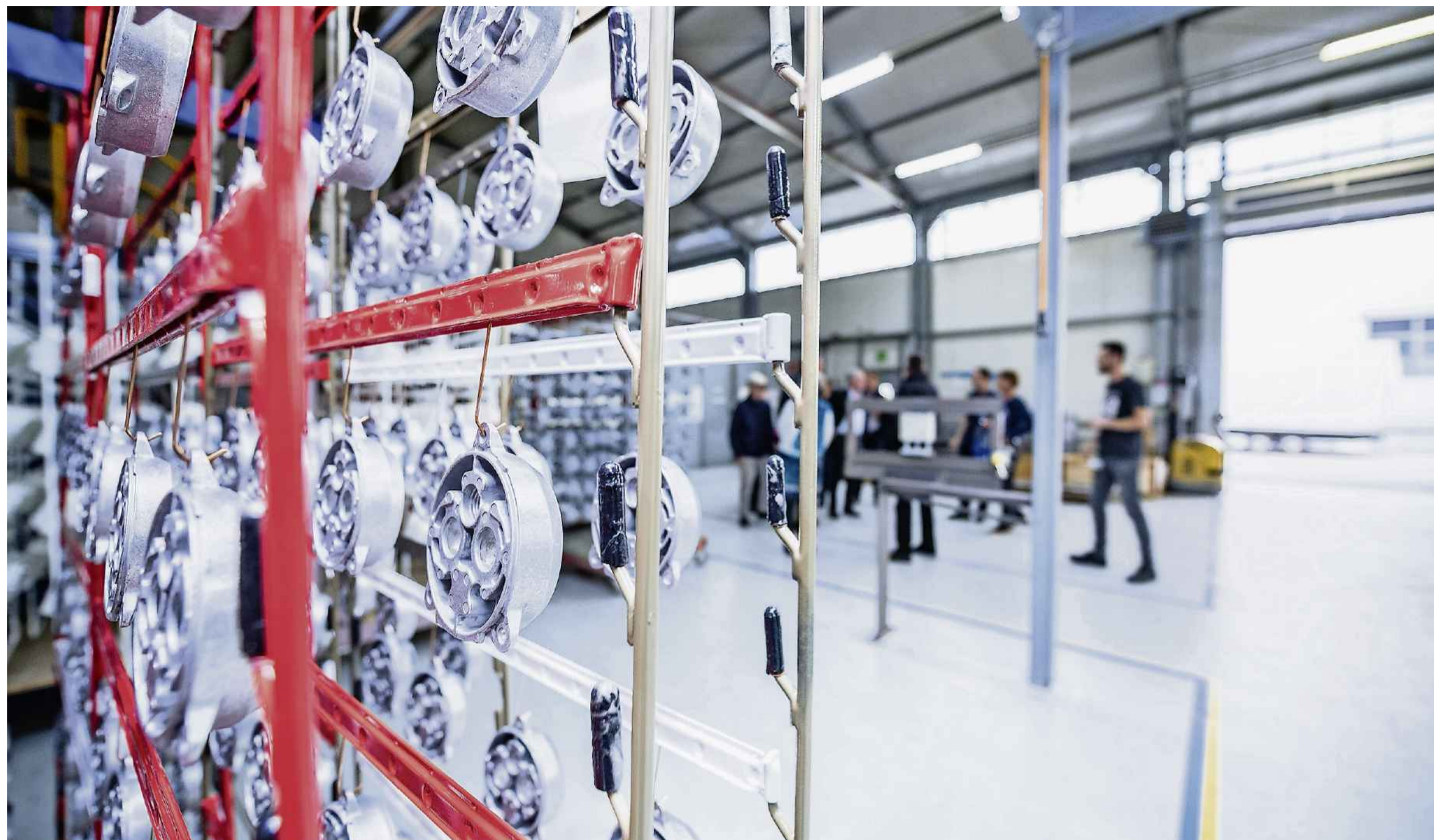
Die Brönnimann AG mit Sitz in Derendingen lackiert Teile in allen Grössen und Formen für Firmen wie die SBB oder Siemens. Der Lack kann dabei verschiedenste Funktionen erfüllen: Von schmutzabweisend bis antibakteriell.
